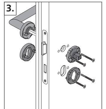
4. **! Achtung prüfen !** Der Vierkant muss mindestens 5 mm aus dem Anker überstehen, um eine perfekte Drückerführung zu gewährleisten!
